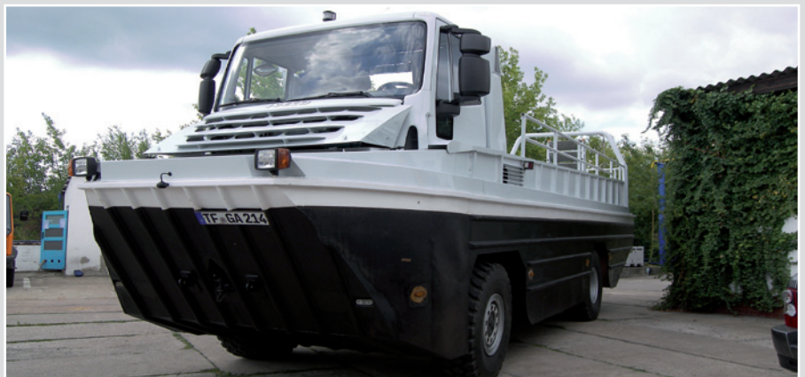
Auf der Basis eines IVECO-LKWs wurde das Amphibienfahrzeug entwickelt. Die Beiträge ihrer Mitarbeiter, die sich neben der alltäglichen Arbeit für das innovative Vorhaben begeisterten, schätzen die Chefs Friedemann und Stephan Hampel sehr. Der Prototyp hat Prüfungen und Probezeit bestanden. Er ist zugelassen für die Fahrt mit 25 Personen.
