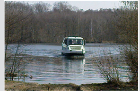
Auch ein IVECO kann schwimmen. Um den Rumpf schwimmfähig zu bekommen, waren umfangreiche Modifikationen an der Karosserie nötig.
