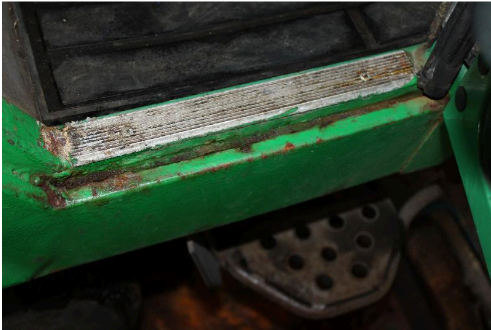
Bild: 15 Einstieg vorne rechts, rostansatz
