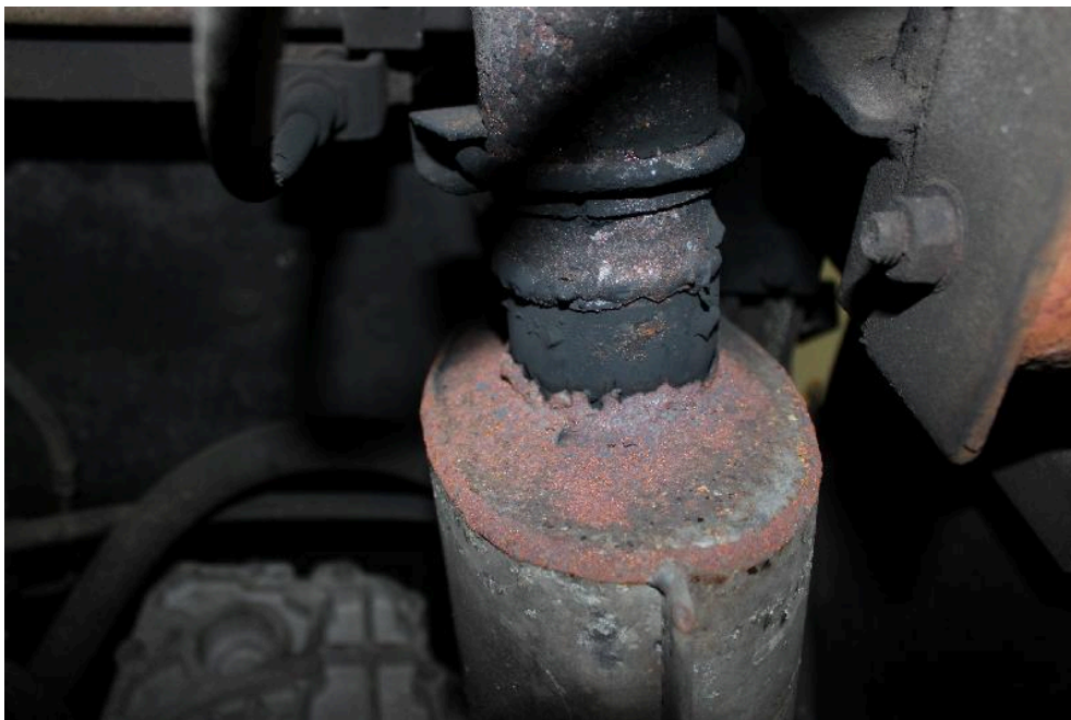
Bild: 28 Auspuff an Schalldämpfer gebrochen
