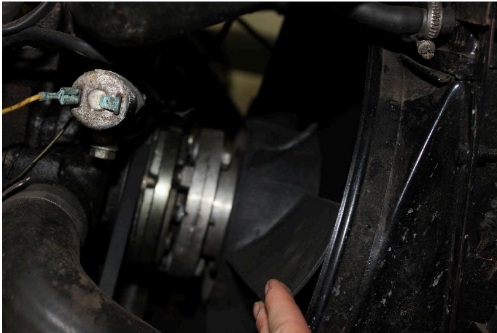
Bild: 37 Lüfferrad gebrochen
