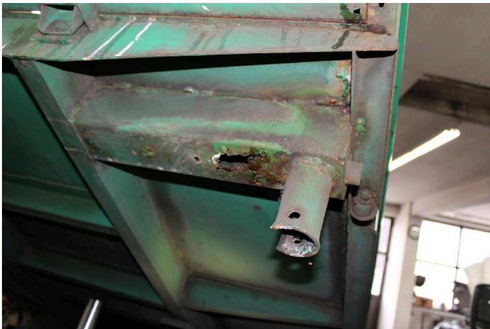
Bild: 34 Pritsche unterseite, Rostloch
