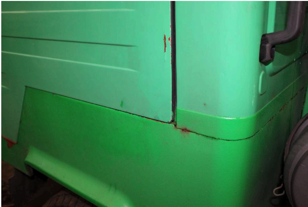
Bild: 19 rostansätze Fahrerhaus links hinten
