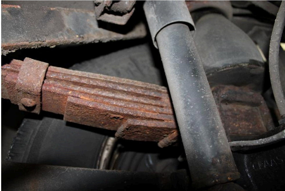
Bild: 29 Federn hinten verschlissen, links
