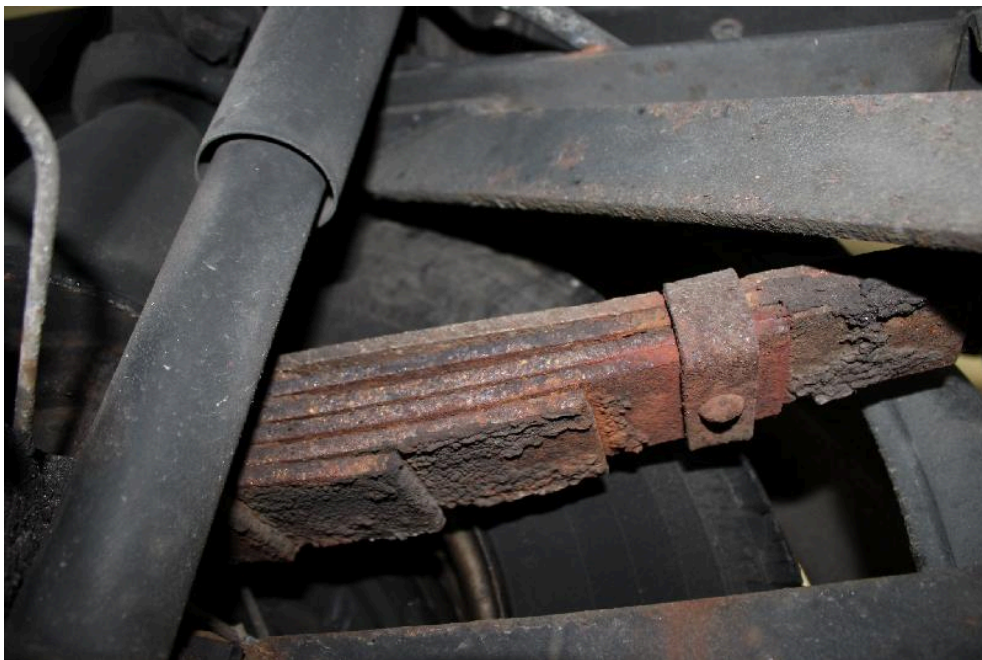
Bild: 30 Federn hinten verschlissen, rechts
