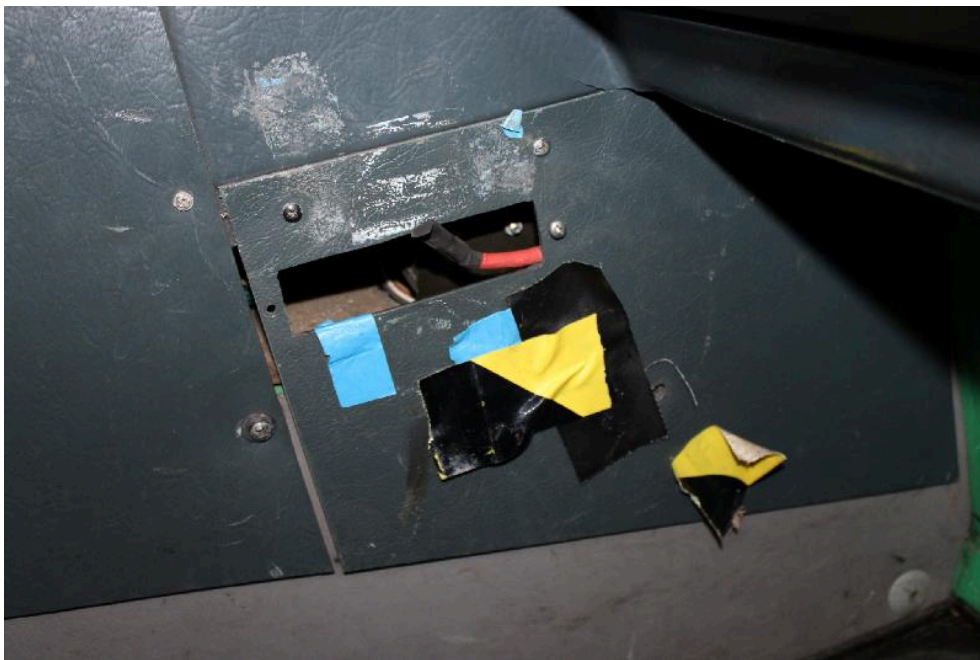
Bild: 14 Fußraum vorne rechts Seitenverkleidung beschädigt
