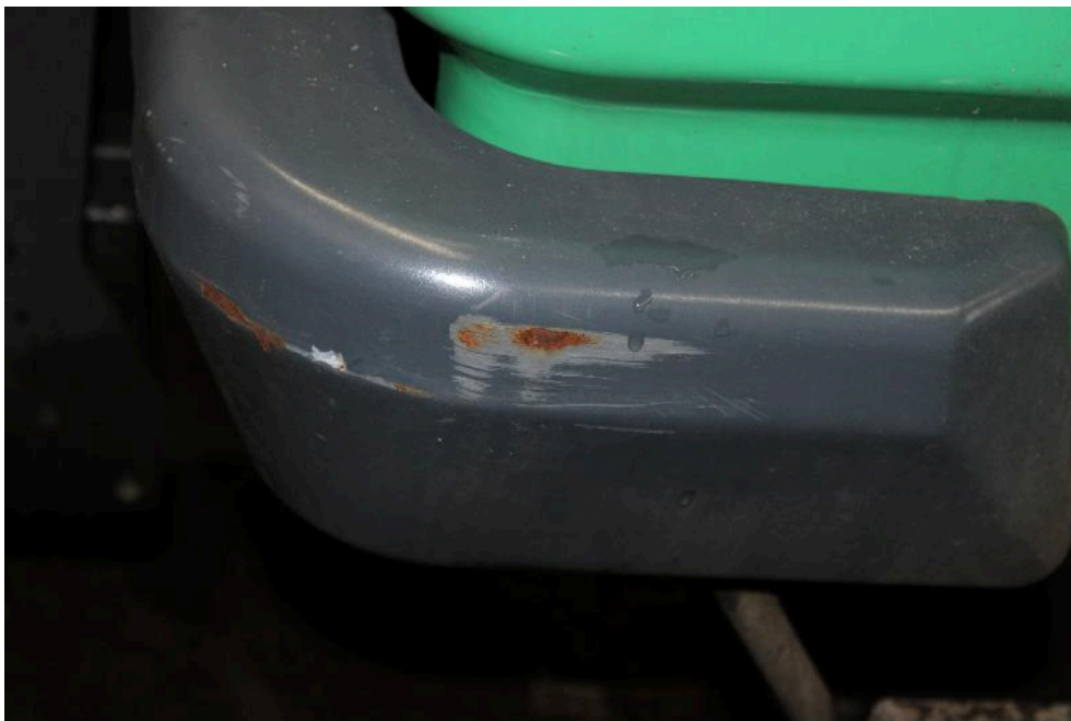
Bild: 18 Stoßstange vorne links angeschrammt
