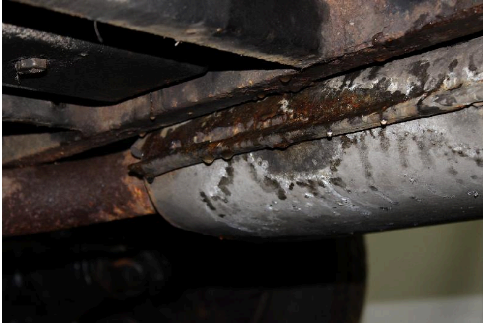
Bild: 33 Hilfsrahmen des Hydraulikbehälters liegt auf Auspuff auf
