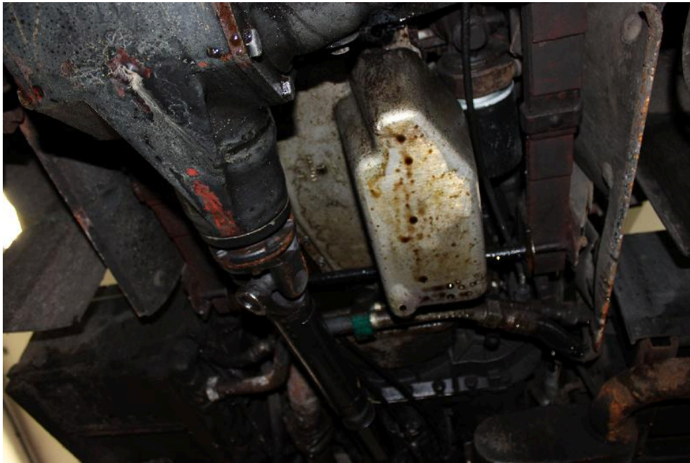
Bild: 27 Motor und Getriebe Ölfeucht
